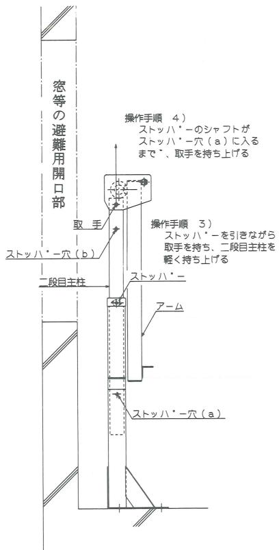
**操作手順 <4>** さらに「取手」を、フレームに付いている「ストッパー」のシャフトが、二段目主柱下部にある「ストッパー穴(a)」(穴は見えない位置にあります)に、「パチン」という作動音がして差し込まれるまで、持ち上げて下さい。
