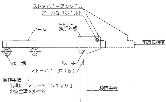
**操作手順 <7>** 「アーム」先端の「吊環」に「スローダン125」の安全環を取り付けて下さい。
