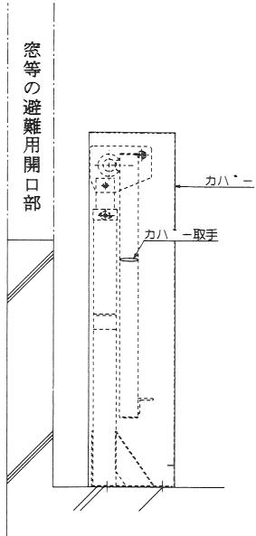
\* 防水型及びセット式のカバーは、二段重ねの茶筒型となっておりますので、カバーに付いている「取手」を持ち、上方に持ち上げて下さい。（「パッキン錠」が付いている場合は、「パッキン錠」を外してから操作して下さい。）
